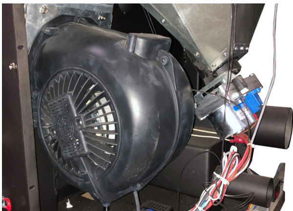
Figure 26 Ventilateur d'échangeur d'air chaud du modèle PSBF66W
