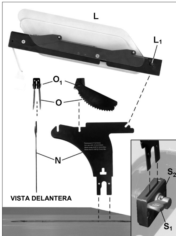
Figura 6-10: instalación del conjunto de protector
