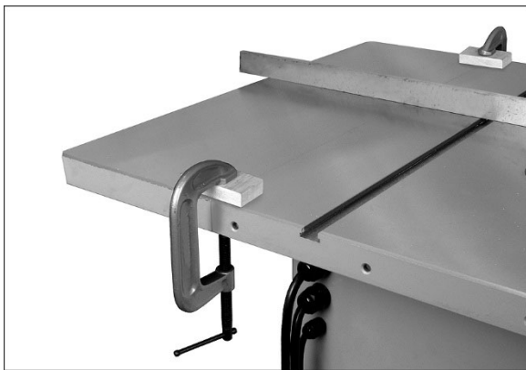
Figura 6-5: nivelación de las alas de extensión, método 2
