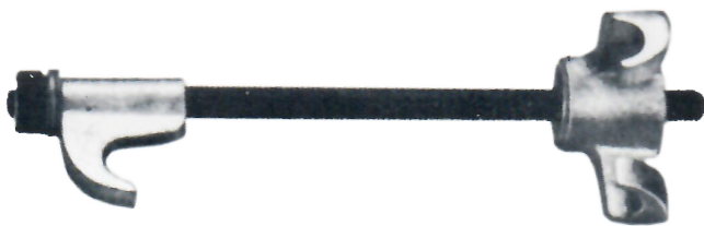
Écrous hexagonaux de 5/8 po entièrement assemblés dans les trous hexagonaux du crochet double.
