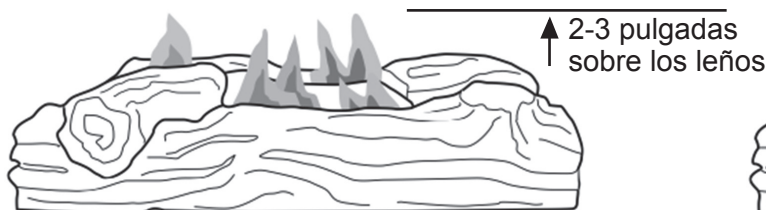
Fig. 22 - Patrón correcto de la llama del quemador
