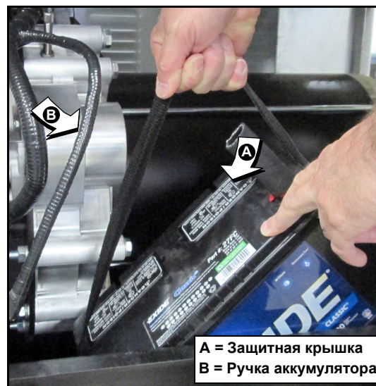
Рисунок 6-6. Установка аккумулятора (модели с объемом двигателя 2,3 л)
