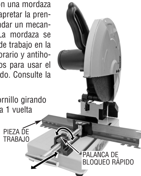
FIGURA 5. USO DE LA PALANCA DE TRABA RÁPIDA
