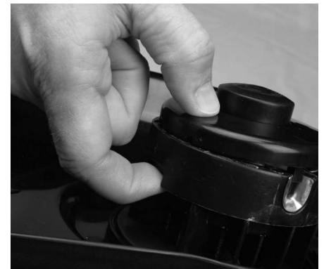
Figure 4-13 : Déverrouillage du couvercle de la bobine
