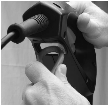
Figura 4-3: Insección del lazo del cordón de extensión por debajo del asa
