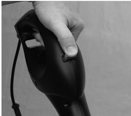
Figure 4-29 : Appuyez sur le bouton de rotation de l'arbre
