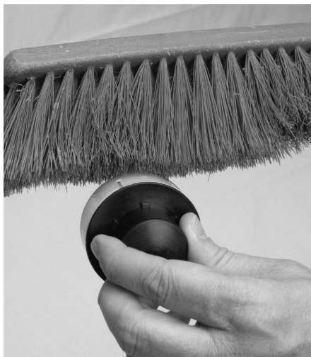
Figure 4-15 : Nettoyage de la bobine
