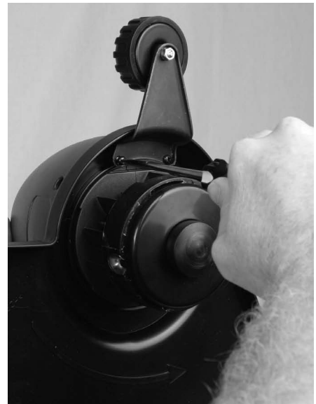
Figura 3-5: Sujeción de la rueda de la recortabordes
