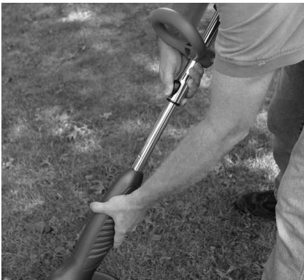
Figura 4-7: Regulación de la longitud del eje
