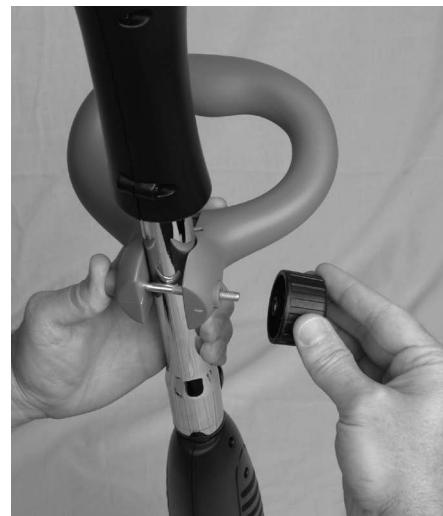
Figura 3-9: Atornillado de la perilla en el perno
