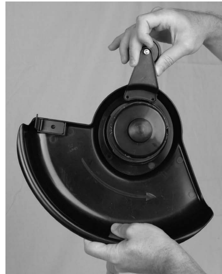
Figure 3-4 : Mise en place du disque de coupe sur les orifices des vis
