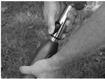
Figura 4-27: Deslizado hacia arriba el botón de desenganche del telescópico
