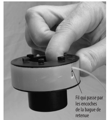
Figure 4-23 : Insertion du fil dans les encoches de la bague de retenue
