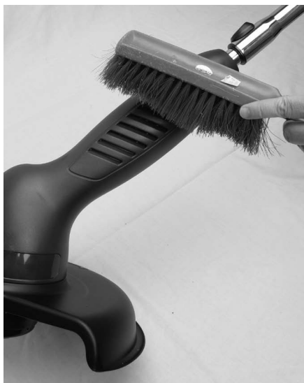
Figure 5-1 : Nettoyage du boîtier du taille-bordures / coupe-bordures
