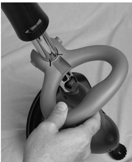
Figure 3-7 : Insertion de la poignée sur l'arbre
