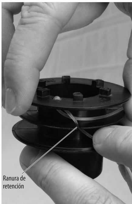
Figura 4-20: Colocación de la cuerda en el carrete
