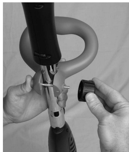
Figure 3-9 : Mise en place du bouton sur l'écrou
