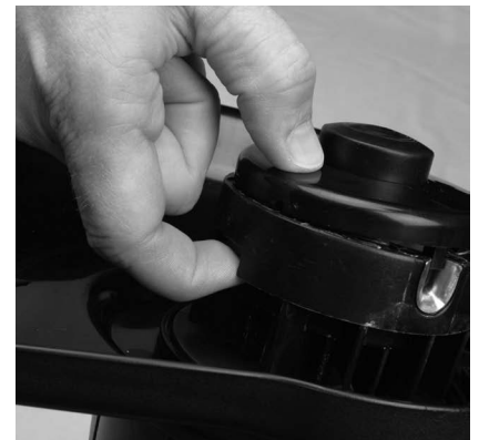
Figura 4-13: Desbloqueando la tapa del carrete
