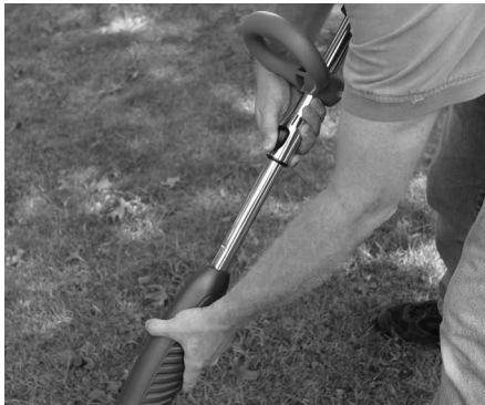
Figura 4-28: Regulación de la longitud del eje
