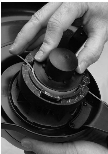
Figura 4-25: Reposición del carrete en la carcasa
