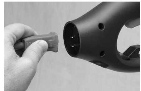
Figura 4-2: Enchufando el cordón de extensión en el enchufe de alimentación. Modelo RM112ST
