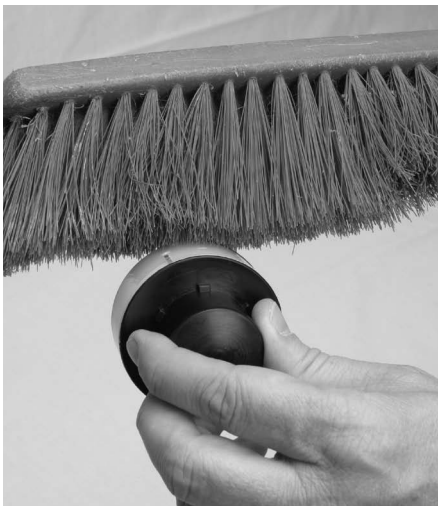
Figura 4-15: Limpieza del carrete
