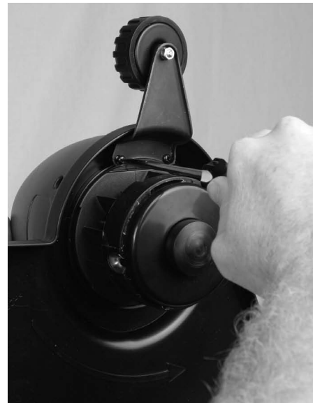
Figure 3-5 : Fixation du disque de coupe
