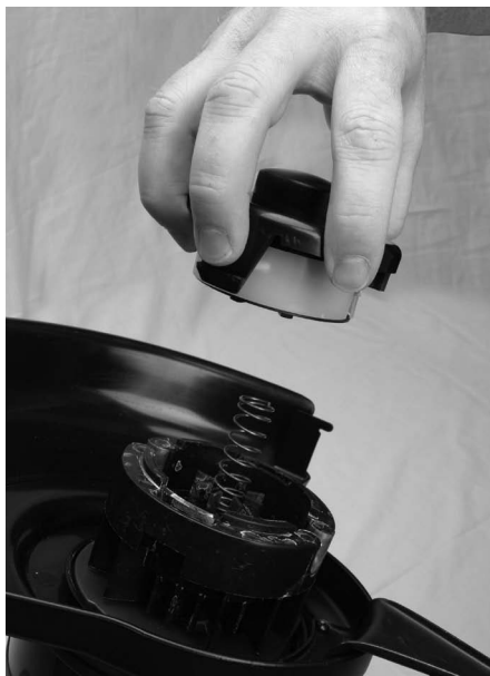
Figure 4-14 : Retrait du couvercle de la bobine et de la bobine
