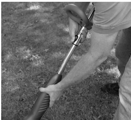
Figure 4-7 : Réglage de la longueur de l'arbre
