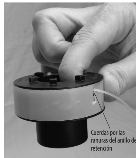
Figura 4-23: Ubicación de la cuerda en las ranuras del anillo de retención
