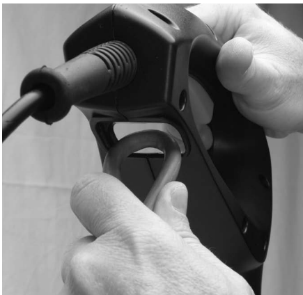
Figure 4-3 : Insertion de la boucle de la rallonge électrique dans la partie inférieure de la poignée
