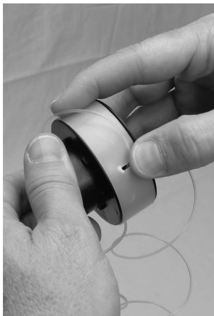
Figure 4-24 : Enroulement du fil sur la bobine
