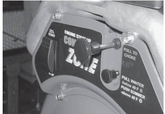
Schéma 17 - Position d'étrangleur plein
