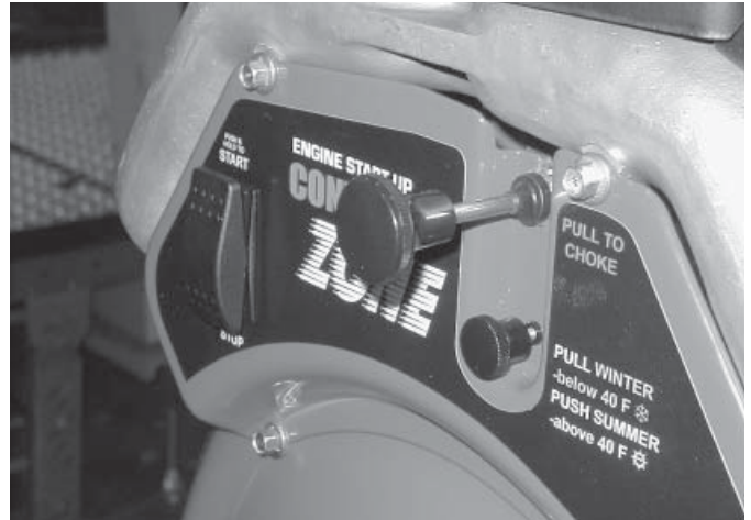
Figura 17 - Posición Full Choke
