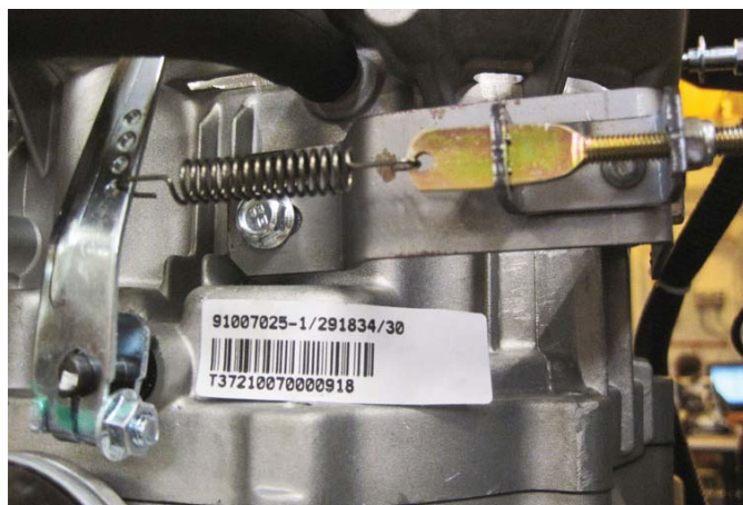
Figura 2.1 — Ajuste del gobierno del motor en motores de un cilindro
