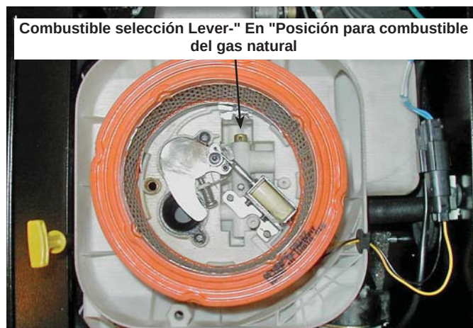
Figura 1.8 - GT-990/GT-999 de 12, 14, 16, 17 y 20kW (cubierta de la caja de aire desmontada)
