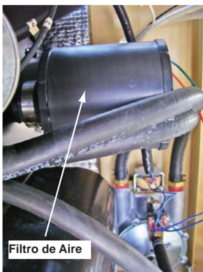
Figura 4.6 — Limpiador de aire del motor de 10kW
