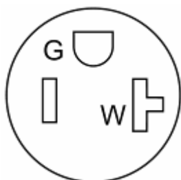
Figure 1. Prise de courant double NEMA 5-20R : 125 volts, 20 A avec disjoncteur de fuite à la terre
