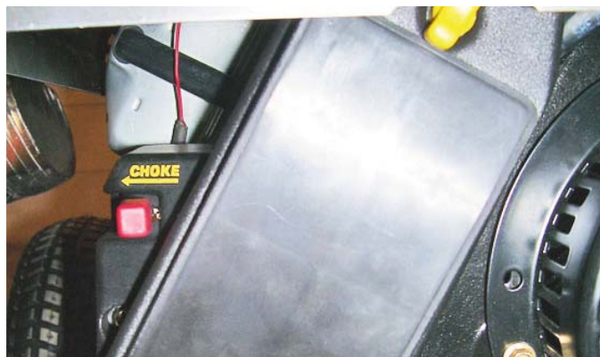
Schéma 11 - Position de l'étrangleur
