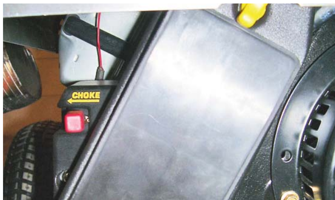
Figura 11 - Posición de Choke
